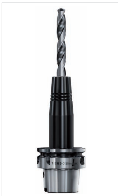
Tenký hydrorozpínací upínač TENDO Slim 4ax sa osvedčil pri axiálnom obrábaní s vysokou presnosťou a excelentným tlmením vibrácií. V automobilovom priemysle môže nahradiť teplom sa zmršťujúce prevedenie upínačov bez námahy preprogramovania 1 : 1.
