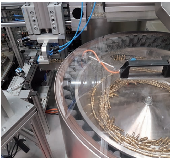
Automatická orientácia čapov vibračnými zásobníkmi
